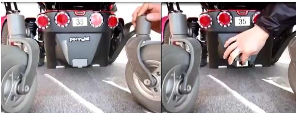
旧タイプではブレーカースイッチが付いていません。コントローラーのコネクターを取り外す事で誤作動を防止します。
