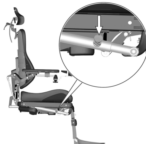
図18. レッグレスト角度の手動調節
