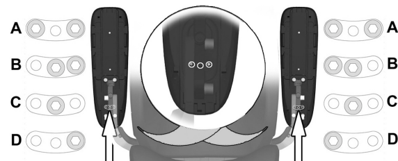
図25. アームレストの回転とボルト位置
