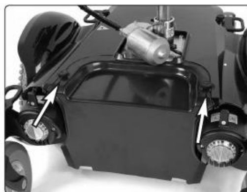
前部カバーは2つのネジで取り付けられています。
