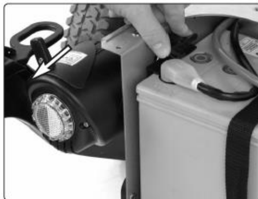
バッテリーがバッテリーロックで固定されているモデルもあります。
