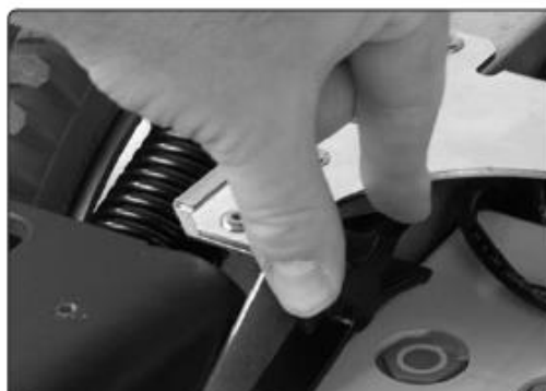
バッテリーがバッテリーロックで 固定されているモデルもあります。
