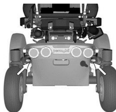
図 144. 車椅子リヤにある 運搬用固定金具
