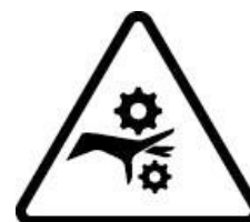
図 166. 挟まれる危険性あり
