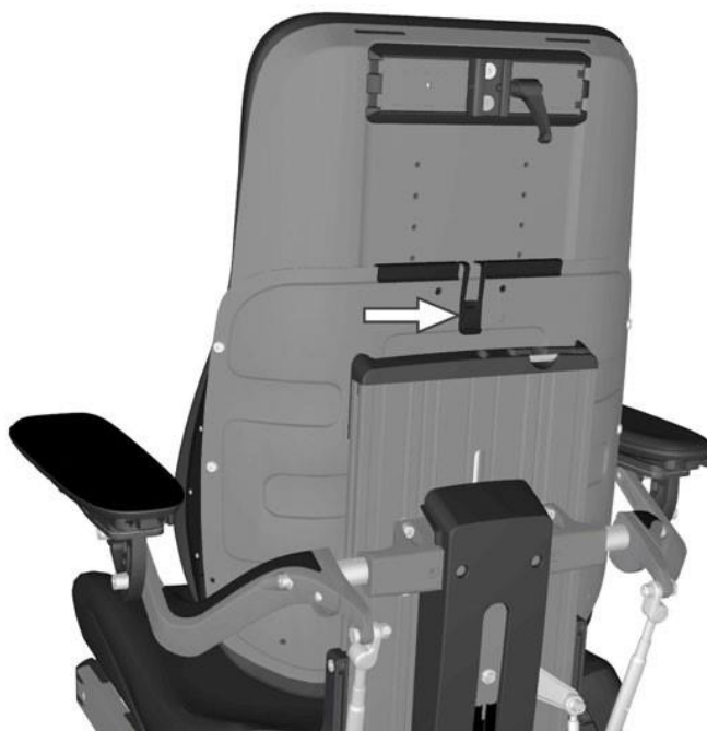
図 145. バックレストの上部はツメでロックされています。
