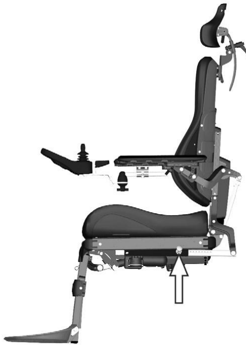
図 16. バックレスト・リクライニング用の手動ロックチューブ
