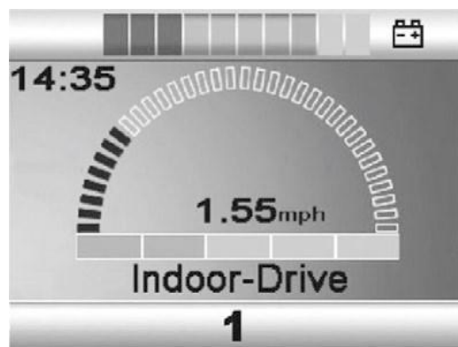
図 99. 速度計の表示のある標準のディスプレイ画面
