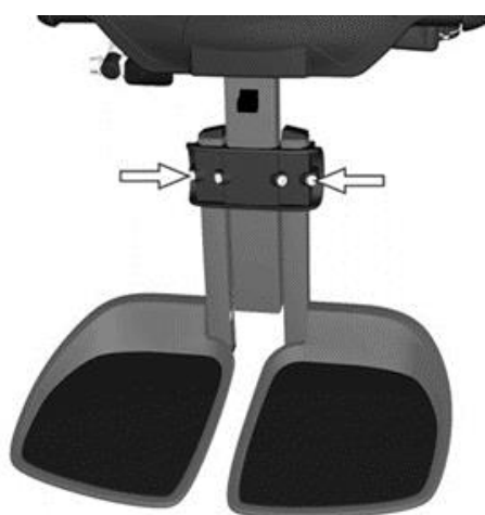
図 24-1. フットプレートの高さは2ヶの外側のロックネジで調節できます。
