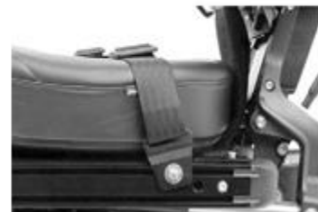
図 21. シートベルト固定： (シート左側の例)
