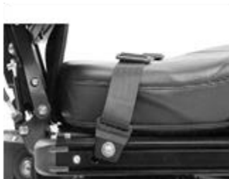
図 19. シートベルト固定： (シート右側の例)
