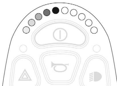
図 130. LED が左右に動きエラー を表示
