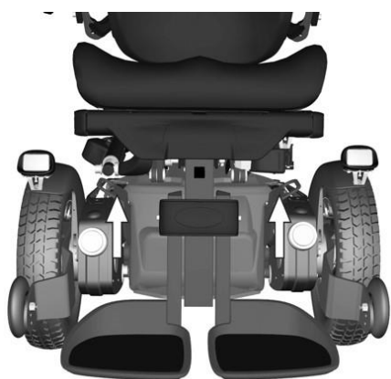
図 142. 車椅子フロントにある 運搬用固定金具
