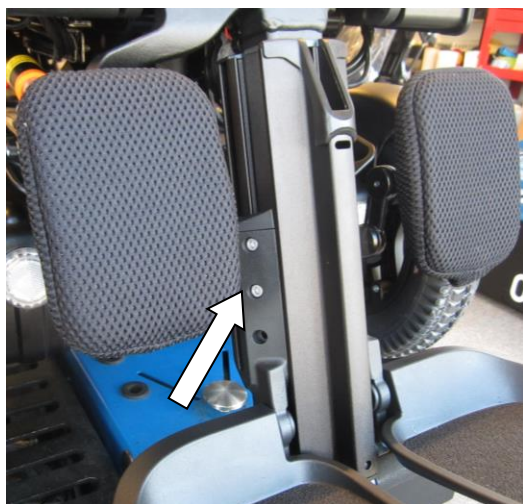
図 24-2. フットプレートの高さは2ヶの ロックネジで調節できます。 (図は右フットプレートの場合)
