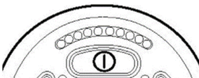
図 73. バッテリー電圧表示計
