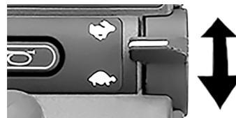
図 37. Bluetooth®モードでは上下にスクロールするために右パドルを使用します。
