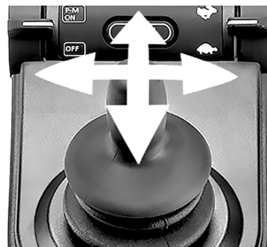
図 40. Bluetooth®を使用すると、ジョイスティックでマウス機能をコントロールできます。
