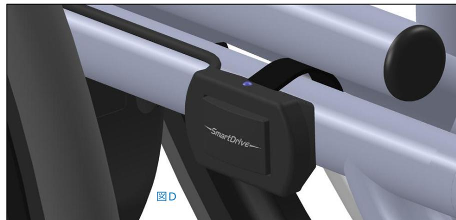
2. ボタンは、ケーブルを割くことで、ご希望の場所（座席後部が望ましい）まで引き離すことができます。付属の結束バンドを使い、ケーブルをフレームのチューブに這わせて車いす後部の外に出します。ケーブルがはみ出して車いすのスポークに巻き込まれることがないようにします（図 E）。
