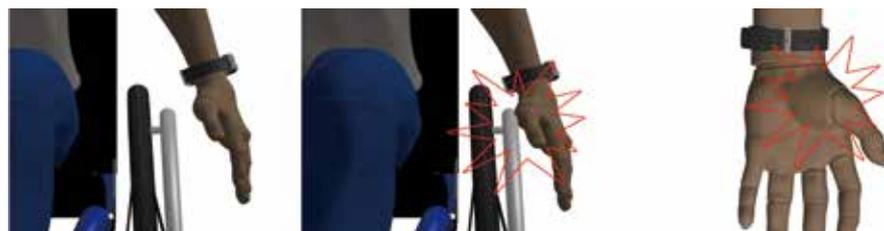
この動作でモーターを停止した場合、PushTracker/E2 は、インジケータ [PushTracker の LED または PushTracker E2 のスクリーン] が赤く点灯する以外に、インジケータの電力が停止すると、振動を発生させます。
