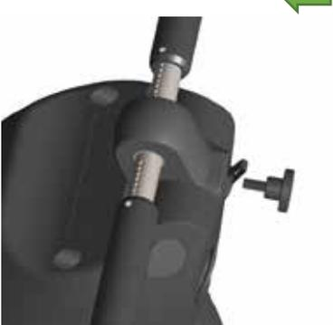
5. 駆動ユニットをアダプターバーに固定します(図.M)
