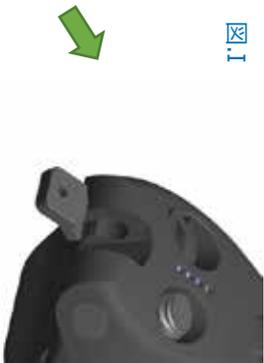
2. ドライヴユニットを取付け突起部に沿って下に動かす(図.J)
