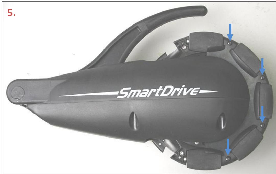
6. ホイールを回し、残りの3個のローラーを取付けます。
