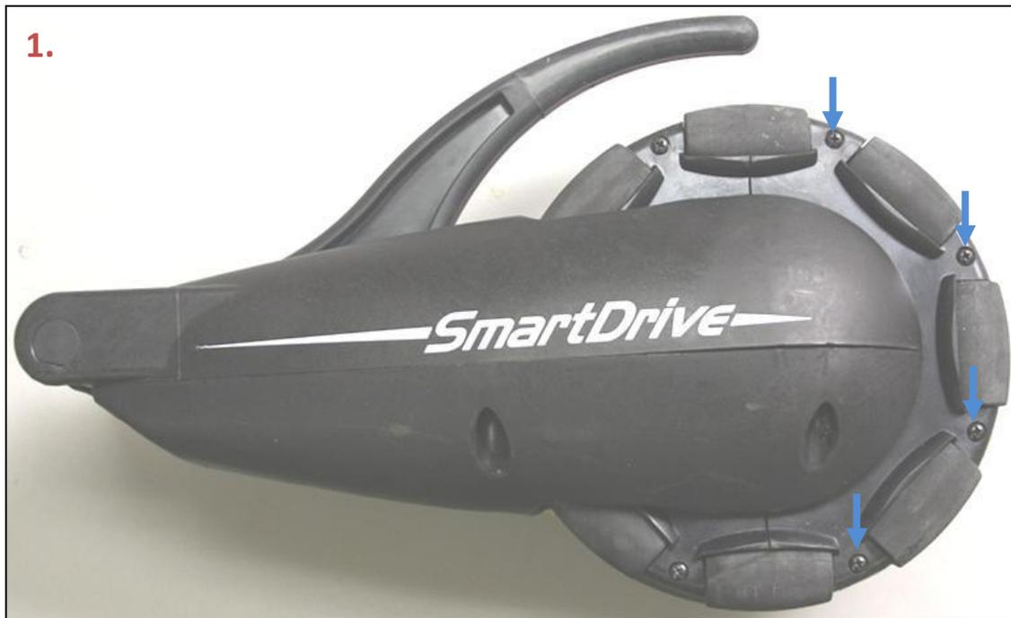
2. 同様に、#2プラスドライバでホイールカバーをドライブユニットの反対側で、半分取付けている4個のネジを外します。再度、ネジを緩める際はネジの頭をしっかりと押さえて下さい。押さえが甘いとネジ穴をつぶしてしまいます。テコの原理でホイールカバーを半分開け、残りの5つのローラーを外します
