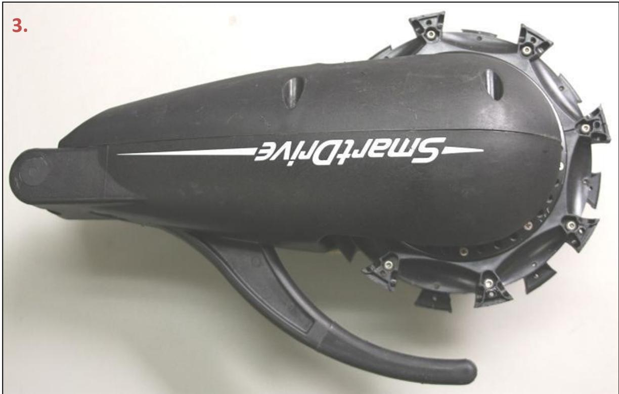
4. 5個の新しいローラーをドライブユニット・ホイールに載せます。
