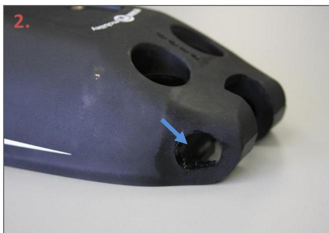
3. 新しいキャップを押して穴に押し入れ、上向きにして45分間、完全に乾く迄、そのままにしておきます。乾燥したら、キャップを曲げて穴に入れます。
