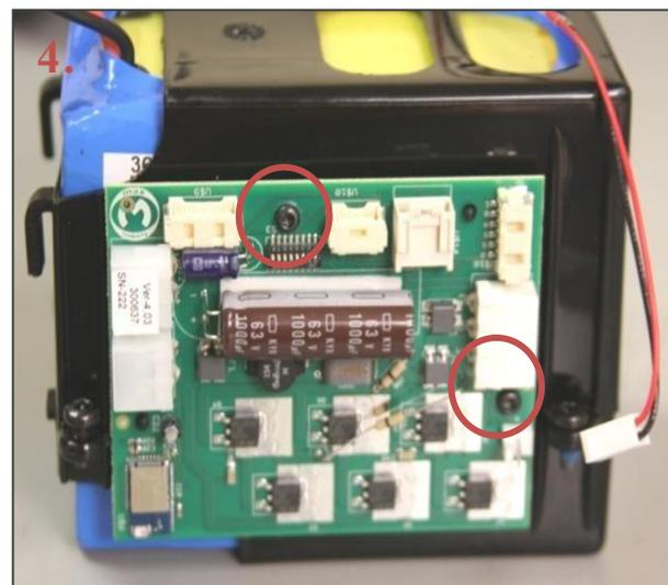
4. T10トルクスレンチで2個のネジを外し、古い回路基板を新しい回路基板と交換します(図5参照)。
