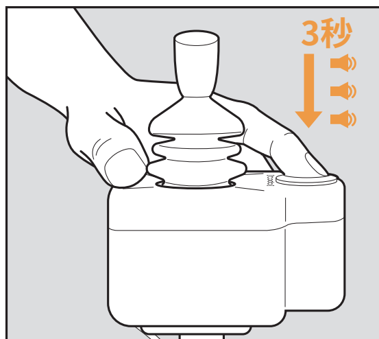
③ ジョイスティックに触れずに電源ボタンを3秒間押ししてください。起動音(呼び出し音)とともに電源ボタンのLEDが点灯するか確認してください。
