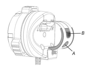
ラバーインサートの配置についての注意点(パート2の説明参照)。取り付けの際、ラバーインサートをクランプの中に入れる事になります。正しく配置するために、『A』はクランプの丸い開口部に、『B』は繰り込みにフィットするようにします。
